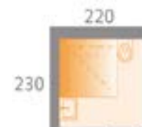
Flächenbedarf Sanitärraum mit Dusche, WC und Waschtisch
